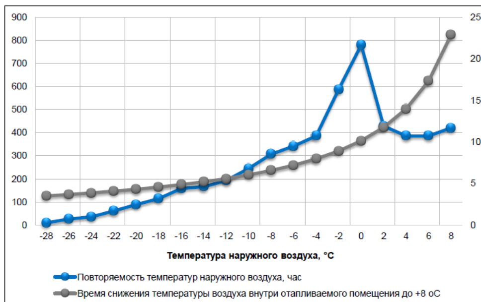
Рисунок 2. Время снижения температуры воздуха внутри отапливаемого помещения до +8 °С
