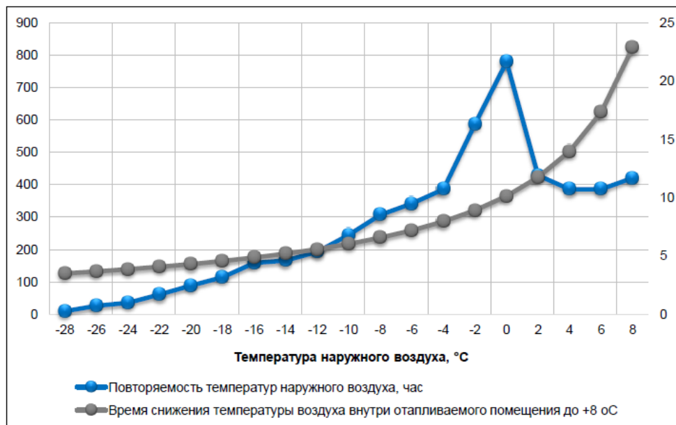
Рисунок 2. Время снижения температуры воздуха внутри отапливаемого помещения до +8 °C
