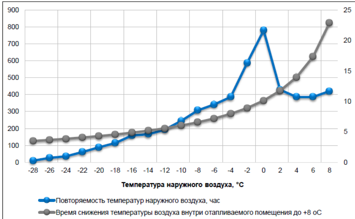
Рисунок 9.7. Время снижения температуры воздуха внутри отапливаемого помещения до +8 °С
