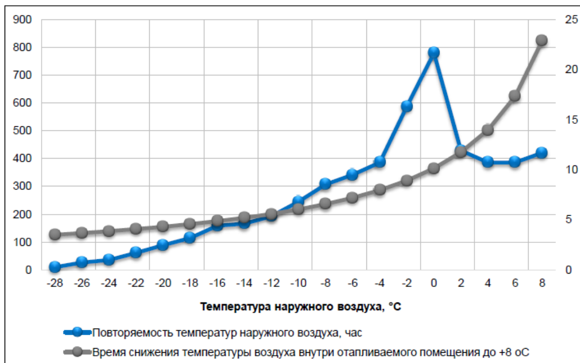
Рисунок 9.7. Время снижения температуры воздуха внутри отапливаемого помещения до +8 °С
